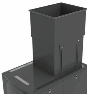
**ПРИМЕЧАНИЕ:** «Каминные трубы» совместимы только с вариантами шкафов VersaPOD глубиной 1200 мм (48 дюймов), в маркировке которых используется обозначение VP2, V62, V82. При этом рекомендуется использовать сплошные тыльные дверцы.
