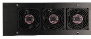
**VP-FAN-220** ..... Панель с вентиляторным блоком для установки в крышку шкафа, 3 вентилятора макс. воздушный поток  $3 \times 3.12 \text{ м}^3/\text{мин}$  ( $3 \times 187.2 \text{ м}^3/\text{час}$ ), 220 В переменного тока, вилка C13
