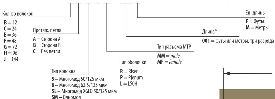
\* Длина сегментов измеряется от наконечника разъема на одном конце до наконечника разъема на другом конце. Длина дуплексных «хвостов» LC в оболочках составляет 1 м (3.3 фута).
