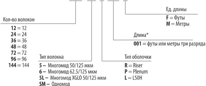
\* Длина сегментов измеряется от наконечника разъема на одном конце до наконечника разъема на другом конце. В «многохвостых» конфигурациях длина «хвостов» составляет 1 м (3.3 фута).
